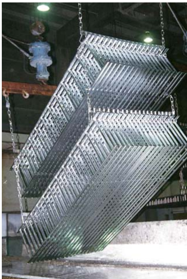
Obr. 7-1 – Žárové zinkování kabelových roštů. Sklon závěsu usnadňuje odtékání přebytečného zinku.
