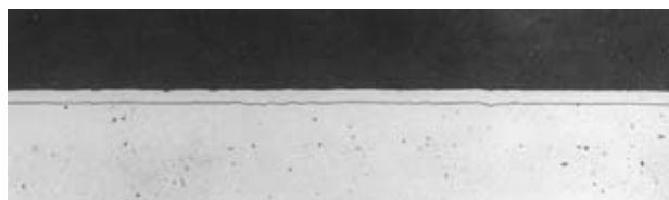
Obr. 3-1 – Řez elektrolyticky naneseným povlakem zinku.
