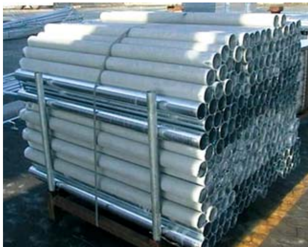
Obr. 5-7 – Žárově zinkované roury s různým obsahem křemíku. Některé jsou vyrobeny z oceli uklidněné hliníkem a získaly kovově lesklý povrch, zatímco jiné byly vyrobeny z oceli uklidněné křemíkem a získaly matný, šedý povrch.
