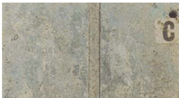
Obr. 10-10 – Stopa široká 6 mm, která se vyleptala v povlaku o tloušťce 60 \mu\text{m} až k povrchu oceli. Vzorok byl pět let exponován v náročném, průmyslově přímořském prostředí v Nizozemsku. Za povšimnutí stojí povlak zinečnatých solí ve stopě, stejně jako absence průniku rzi.
