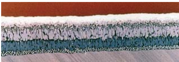
Obr. 5-1 – Schematický řez strukturou zinkového povlaku. Nejvýše je vrstva éta-fáze s 0,03 % Fe, pod ní zeta-fáze s 5,8 až 6,7 % Fe, delta-fáze se 7 až 11 % a gamma-fáze s 21 až 28 % Fe.
