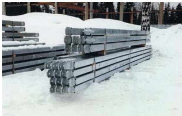
Obr. 10-16 – Žárově zinkované zboží připravené k dodávce zákazníkovi.
