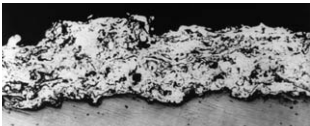
Obr. 3-3 – Řez žárově stříkaným povlakem zinku.
