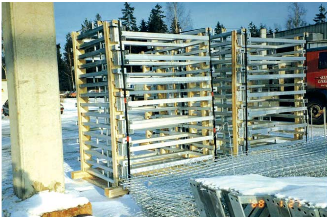
Obr. 10-17 – Způsob balení zboží, který umožňuje provzdušnění a chrání před nárazem.
