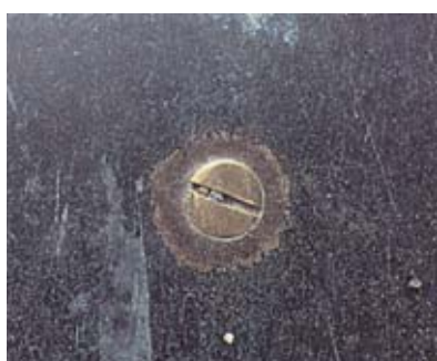
Obr. 10-13 – Mosazný šroub v žárově zinkované oceli způsobuje napadení zinku.
