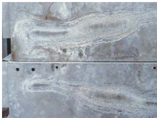
Obr. 10-4 – Bílá rez vytvořená mezi materiálem naskládaným na sebe.
